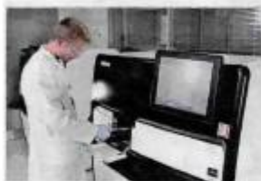
Laboratorio DiAsorin nello stabilimento di Sotgiù, nato grazie ai tecnici sabbotati per lavorare nel esule. A sinistra: una macchina Liaison XL per analisi di immunodiagnostica
